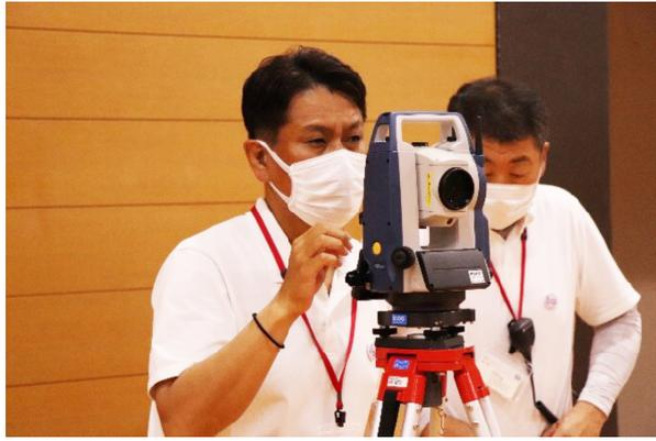
測量士による距離計測の様子
